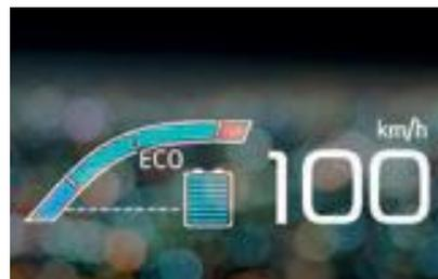
Dispõe também do sistema *Head Up Display*, que projeta (a cores) no parabrisas informações úteis como: velocidade, sinais de trânsito, carga da bateria, entre outros, facilitando assim a sua leitura sem “tirar os olhos” da estrada. Estes sistemas de segurança facilitam a condução e incrementam a segurança.
