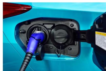
Tal como nos veículos puramente elétricos, o carregamento das baterias pode ser feito de duas formas - através da recuperação de energia nas travagens (regeneração) e através de uma tomada elétrica (doméstica ou em postos de carregamento públicos).
